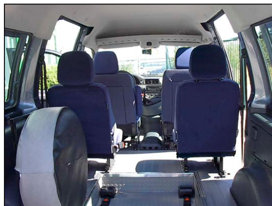
Option: bis zu 2 Einzelsitzen mit Schnellverschlüssen in der ersten Fahrgastreihe
