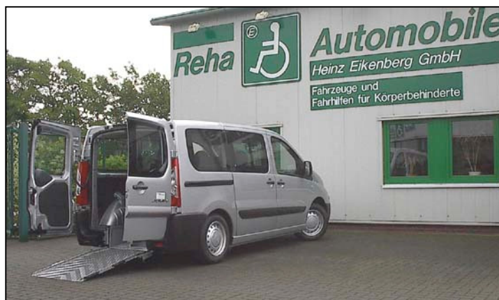
Fahrzeug einfahrbereit abgesenkt
